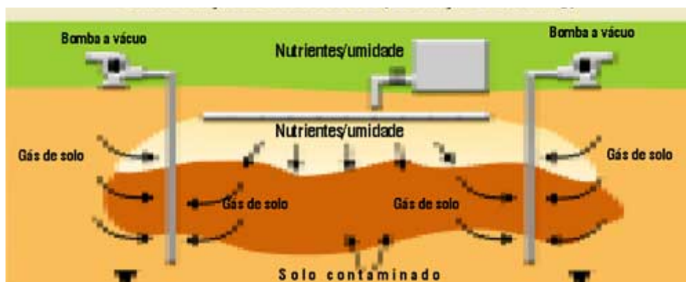
Figura 14: Esquema de como funciona a bioestimulação em terra.
